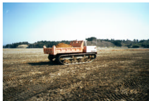
（面積A = 15.03haに、土量V = 1,672m³を運搬した10tダンプキャリア）
